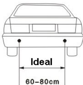
Bei der Montage von zwei Sensoren
